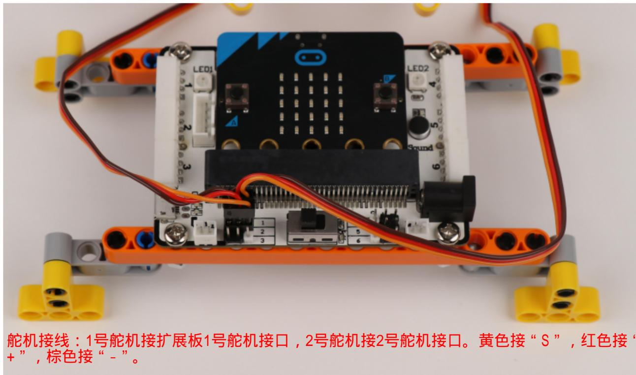
舵机接线：1号舵机接扩展板1号舵机接口，2号舵机接2号舵机接口。黄色接“S”，红色接“+”，棕色接“-”。
