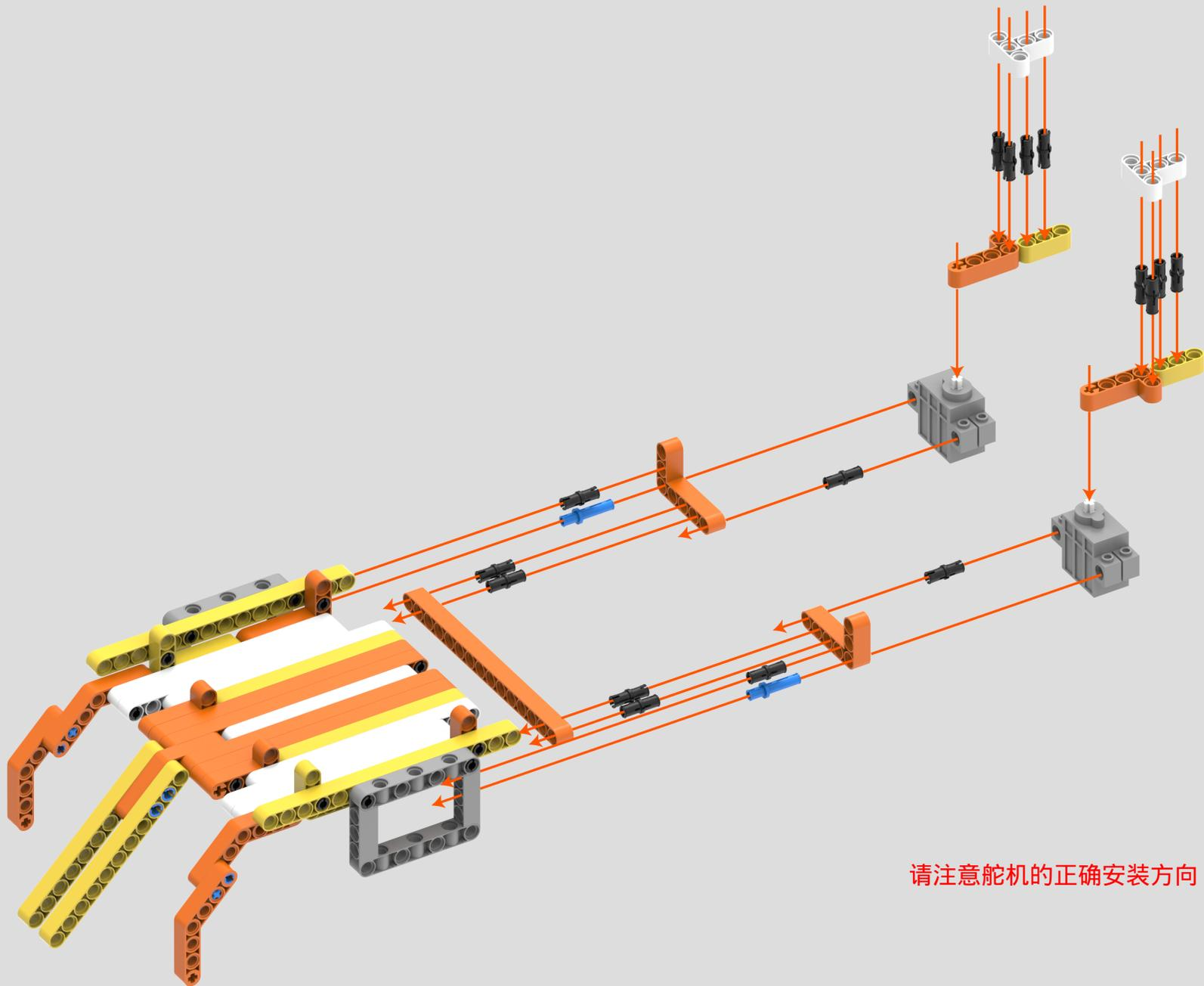
请注意舵机的正确安装方向
