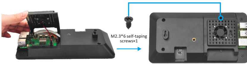
Install Door with fan
